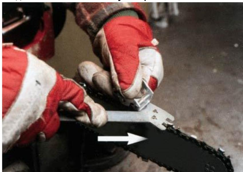
Шина – один из определяющих компонентов пильной гарнитуры. Длина шины влияет на глубину реза: чем она длиннее, тем с большим диаметром ствола может справиться бензопила. Однако обязательно следует учитывать, что длина шины должна быть согласована с мощностью пилы. При недостаточной мощности двигателя Вам придется прилагать дополнительные усилия при пилении, а это неизбежно приведет к преждевременной изнашиваемости пильной гарнитуры и двигателя, а также к увеличению расхода топлива.
