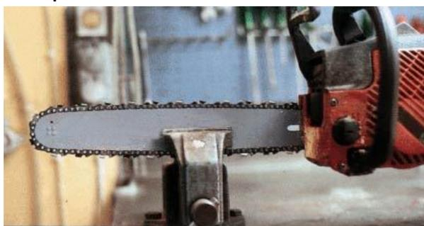
Заточку цепей следует доверить специалисту по заточке цепей (а не просто точильщику). Подправлять цепь в домашних условиях следует цилиндрическим напильником соответствующего диаметра. Ниже описан процесс правки пильных цепей.
