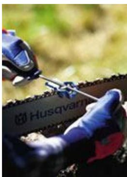
Заточка влияет на усилие, прикладываемое к рукояткам пилы, на производительность работы, на долговечность пильного аппарата. Даже выход цилиндрично-поршневой группы часто происходит из-за попыток пилить тупой цепью.
