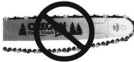
Натяжение цепи особенно важно при валке леса, когда пила наклоняется на бок. Ненатянутая цепь может соскользнуть с шины, что может привести к травме оператора. Слабое натяжение цепи – основная причина повреждения ведущей звездочки. Натяжение цепи.
