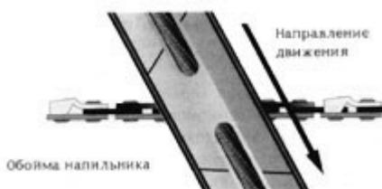
Заточите сначала все режущие звенья с одной стороны цепи. Направление движения заточки от внутренней стороны режущего звена к внешней. Затем разверните пилу на 180° и повторите процесс заточки для другой стороны.
